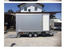
Hebebühnenanhänger , Innenmasse: L 440 x B 215 x H 230 cm Durchlade Breite 196 cm / Höhe: 230 cm, max. Aussenbreite 220 cm Gesamtgewicht 3500 kg, Eigengewicht ca. 1540 kg
